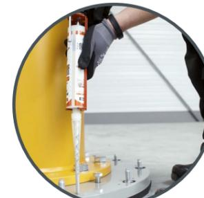
**Schneller Ausgleich von unebenem Boden (max.15 mm)** durch definierte, elastische Auflage mit VETTER-Ausgleichspuffern – aufwändiges Unterlegen entfällt. Verfüllung der Pufferelemente mit schnellhärtendem Spezial-Montagemörtel zur gleichmäßigen Druckbelastung und sofortigen Inbetriebnahme.
